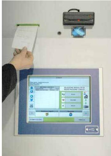
Tras su identificación, el usuario puede pesar la fracción de residuo seleccionando previamente la tipología sobre la pantalla y, posteriormente, depositarlo en el contenedor correspondiente. La **CCA-3E** lleva instalado un software específico, cuya licencia “**CCA-DATA**” es parte integrante del suministro. El software permite el encendido de la Columna por parte de un operario dotado de la tarjeta específica para su propio reconocimiento.
